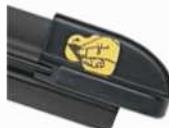
Die Wartungsanzeige besteht aus einem auf dem Wischerblatt aufgeklebten Punkt und einer darüberliegenden Schutzfolie. Nach der Montage der Wischer wird die Schutzfolie entfernt - und die Wartungsanzeige ist aktiviert!
