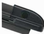
Der Wischergummi wird mit der Zeit spröde. Die Reaktion der Wartungsanzeige: Sie verfärbt sich allmählich von schwarz nach gelb.
